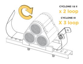
• FOR CYCLONE STRAP LOOP AROUND CABLES
